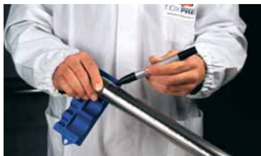
18.ábra – Beillesztési mélység jelölése
